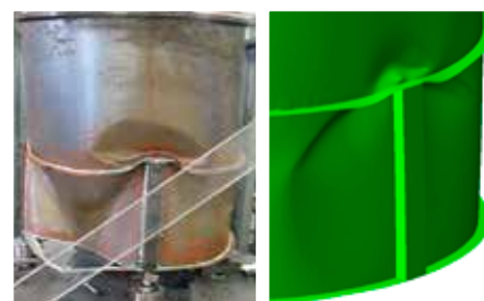
Fig.3 Een schaalmodel na bezwijken versus de numerieke resultaten (Abaqus). _Fig.3 Modèle de coque après rupture par rapport aux résultats numériques (Abaqus).
